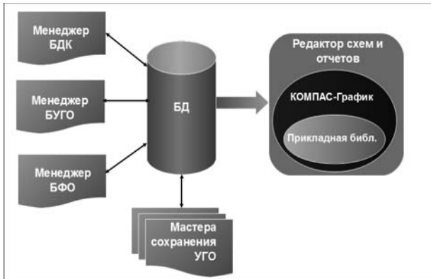
Рис. 1.1. Структура системы КОМПАС-Электрик
