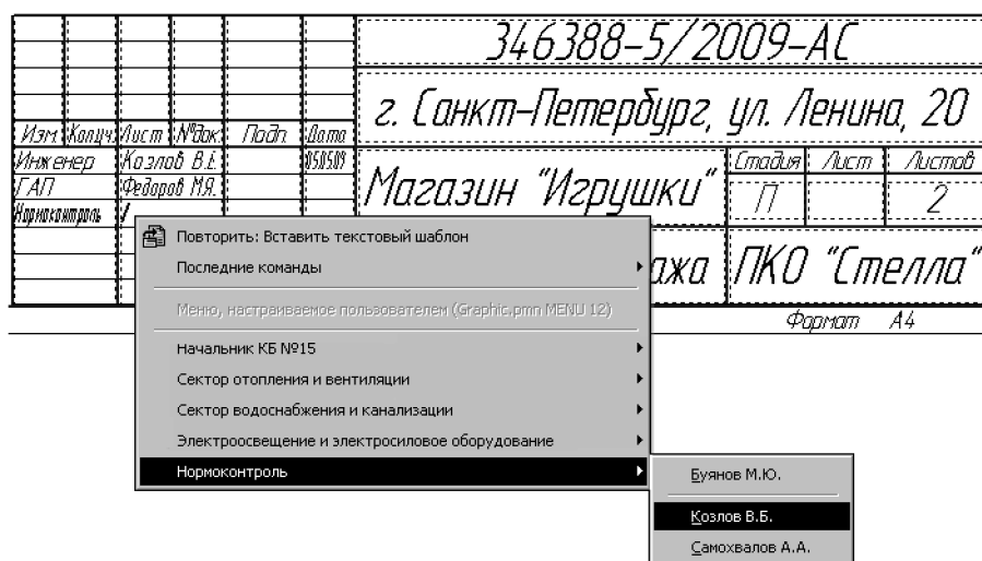
Рис. 127.1. Пользовательское меню при заполнении основной надписи чертежа
