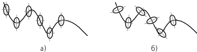
Рис. 47.5. Копирование эллипса вдоль сплайна: а) без доворота копий до нормали, б) с доворотом копий до нормали
