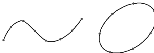
Рис. 23.1. Пример деления кривых (замкнутой и незамкнутой) на равные части
