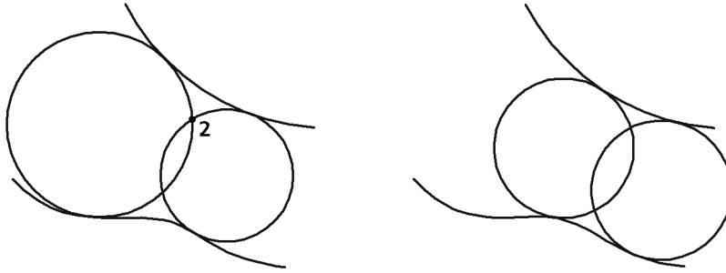
а) б) Рис. 26.5. Окружности, касательные к дуге и сплайну: а) проходящие через точку т , б) равных радиусов
