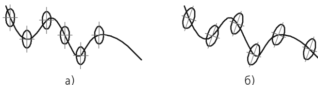
Рис. 47.2. Копирование объектов: а) с сохранением угла поворота и масштаба, б) с изменением угла поворота и масштаба
