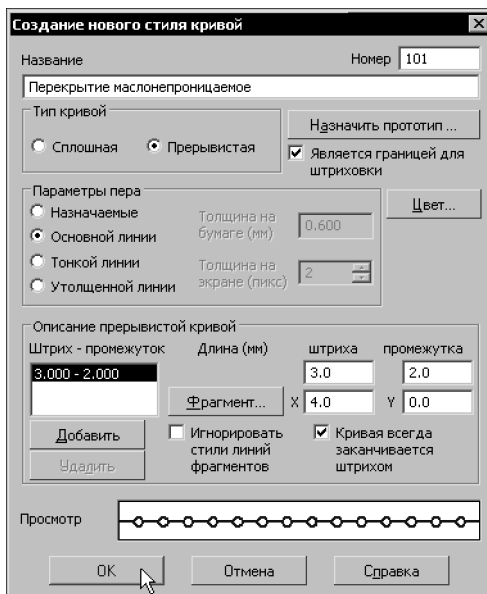
Рис. 130.10. Настройки стиля линии Перекрытие маслонепроницаемое
