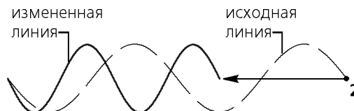
Рис. 43.57. Перемещение характерной точки t2 при активных переключателях Количество полувольт и Значение амплитуды в мм
