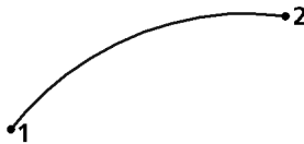
Рис. 28.5. Дуга по двум точкам и углу раствора 60^\circ
