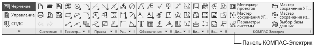
Рис. 16.2. Панель КОМПАС-Электрик в наборе панелей Черчение
