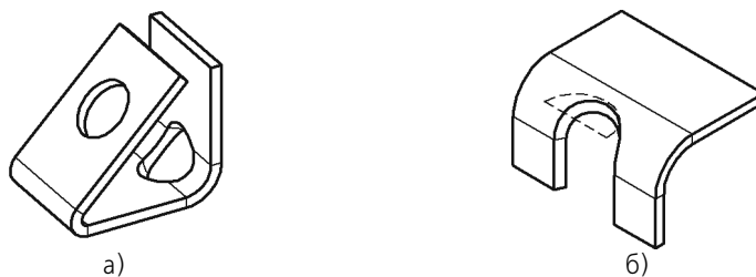
Рис. 41.9. Примеры отверстия и выреза, делающих невозможным разгибание сгиба: а) круглое отверстие, построенное способом На глубину , б) вырез, построенный способом До грани (эскиз выреза, расположенный на верхней плоской грани тела, показан штриховой линией)
