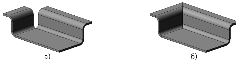
Рис. 38.48. Сгиб вдоль цепочки ребер: а) без замыкания углов, б) с замыканием (один из вариантов)
