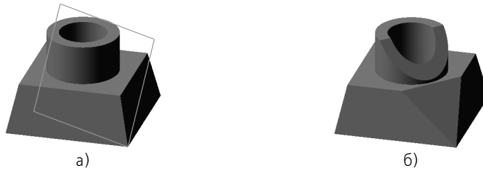
Рис. 30.8. Отсечение части детали плоскостью: а) исходное состояние детали (плоскость отсечения обозначена условно), б) результат выполнения операции отсечения
