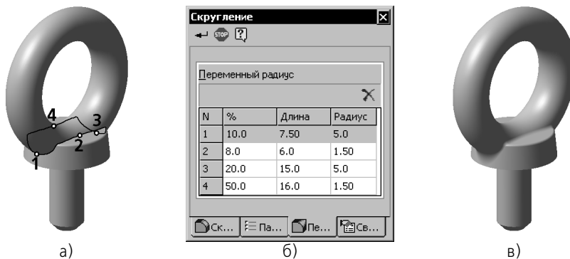
Рис. 30.3. Построение скругления с переменным радиусом: а) указание точек, б) задание параметров скругления, в) результат выполнения команды
