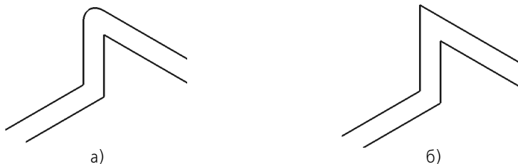
Рис. 46.32. Способы обхода углов: а) обход скруглением; б) обход срезом
