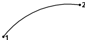
Рис. 118.5. Дуга по двум точкам и углу раствора 60^\circ
