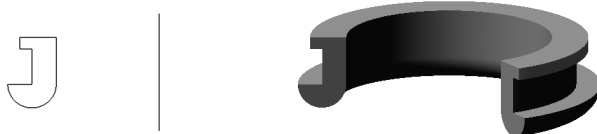
Рис. 24.1. Эскиз, ось и элемент, образованный операцией вращения
