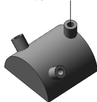
Рис. 55.7. Пример ориентации экземпляров массива по радиальному направлению: а) позиции заданы в цилиндрических координатах; б) позиции заданы в сферических координатах
