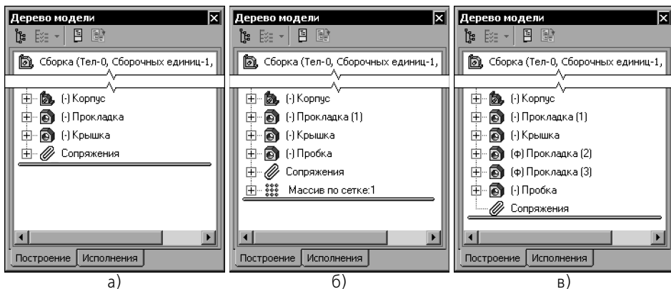
Рис. 50.5. Создание и разрушение массива компонентов
