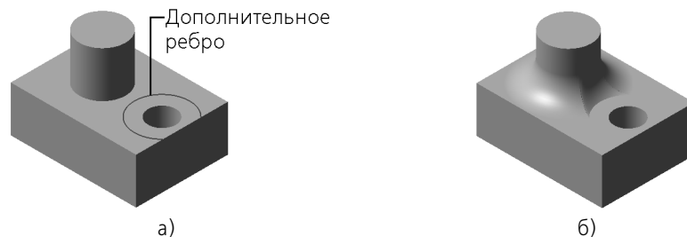
Рис. 48.5. Использование ребра, полученного разбиением грани: а) исходное состояние детали, б) результат построения скругления с сохранением кромки
