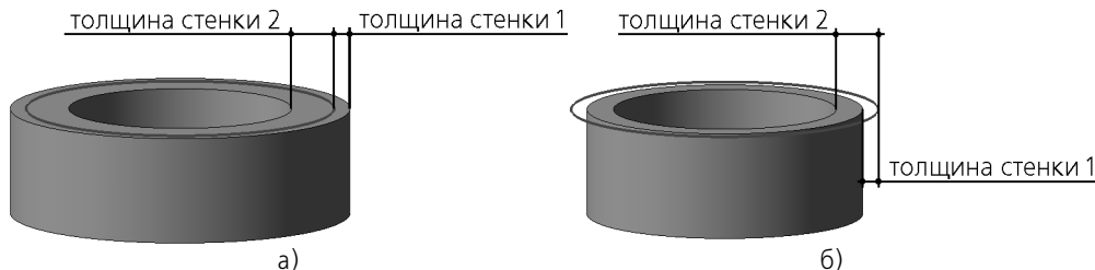
Рис. 23.14. Построение тонкой стенки в двух направлениях (на примере элемента выдавливания; сечение показано утолщенной линией): а) толщина стенки 1 и толщина стенки 2 положительные; б) толщина стенки 2 не изменилась, а толщина стенки 1 получила противоположный знак
