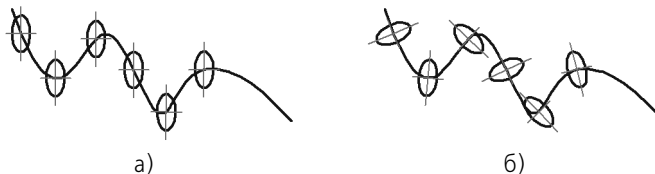
Рис. 138.5. Копирование эллипса вдоль сплайна: а) без доворота копий до нормали, б) с доворотом копий до нормали
