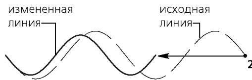
Рис. 133.49. Перемещение характерной точки t_2 при активных переключателях Длина волны и Значение амплитуды в %
