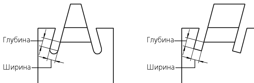
Рис. 38.19. Определение размеров освобождения сгиба при отличном от нуля угле на сгибе
