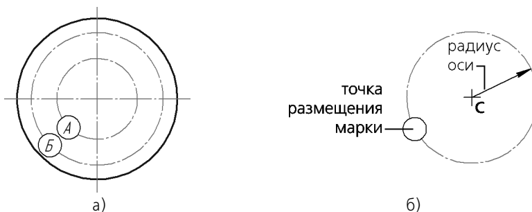
Рис. 134.30. Круговая координационная ось: а) пример использования, б) параметры оси
