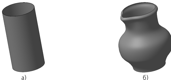
Рис. 49.1. Произвольное редактирование грани: а) исходное состояние грани, б) результат редактирования
