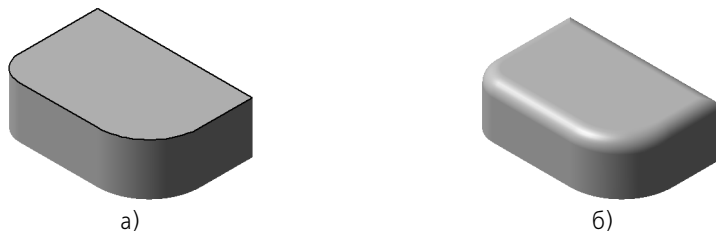
Рис. 30.1. Скругление: а) для построения скругления указана верхняя грань, б) результат построения скругления
