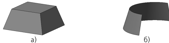
Рис. 47.3. Уклон боковых граней поверхности выдавливания: а) замкнутой, б) незамкнутой
