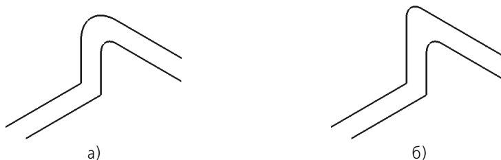
Рис. 46.33. Скругление сегментов эквидистантной кривой: а) без сохранения радиусов; б) с сохранением радиусов
