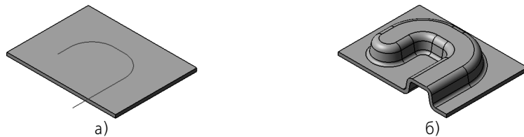
Рис. 42.9. Буртик, не уместающийся в пределах базовой грани: а) эскиз буртика; б) результат построения
