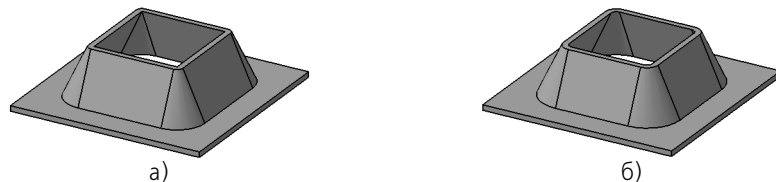
Рис. 42.5. Открытая штамповка с уклоном боковых стенок и скругленными боковыми ребрами: а) радиус скругления равен нулю, б) радиус скругления больше нуля
