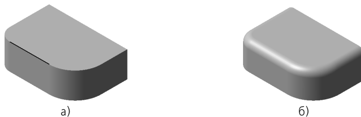
Рис. 30.2. Скругление: а) для построения скругления указано одно ребро и включена опция Продолжать по касательной , б) результат построения скругления
