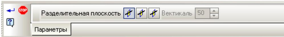
При этом в качестве параметра в операцию **Разбиение поверхности** попадут все поверхности, которые геометрически имеют пересечение с выбранной разделительной плоскостью.
