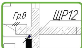
**Инструменты оформления по СПДС.** Простановка выноски маркировок элемента производится автоматически для элементов из каталога строительных элементов с помощью команды Маркер объекта. Воспользуйся командой Выносной фрагмент для получения фрагмента чертежа на плане, разрезе в нужном масштабе.
