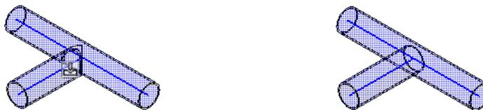
Построение ветвлений: автоматического и без обработки
